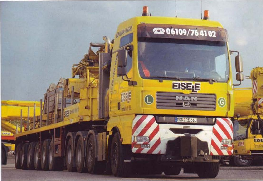
Der MANTGA 660 ist abfahrbereit beladen mit etwa 95 Tonnen Kranballast für den LTM 1500.
