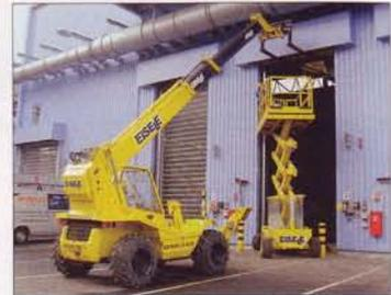
Telestapler und Scherenbühne sind Kleingeräte bei Eisele.
