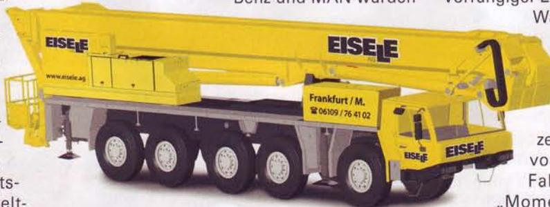
103 Meter Arbeitshöhe bei nur 60 Tonnen Eigengewicht und hoher Geländegängigkeit.
